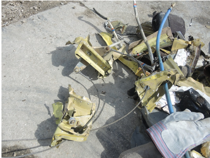
Right aileron bellcrank
