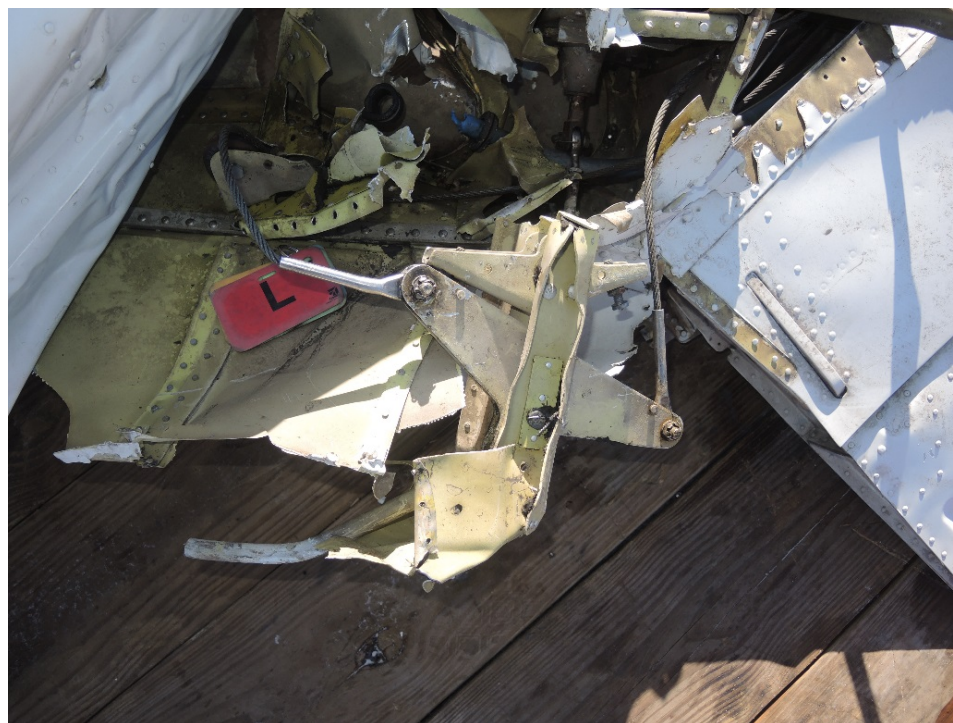
Left aileron bellcrank
