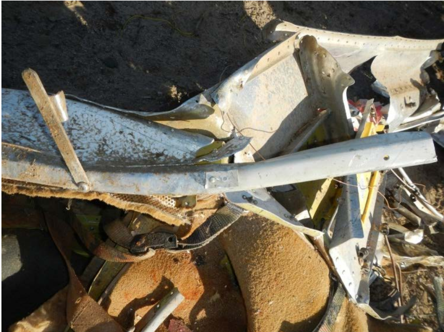
ASI-15-AF-62 Cabin door lower door frame
