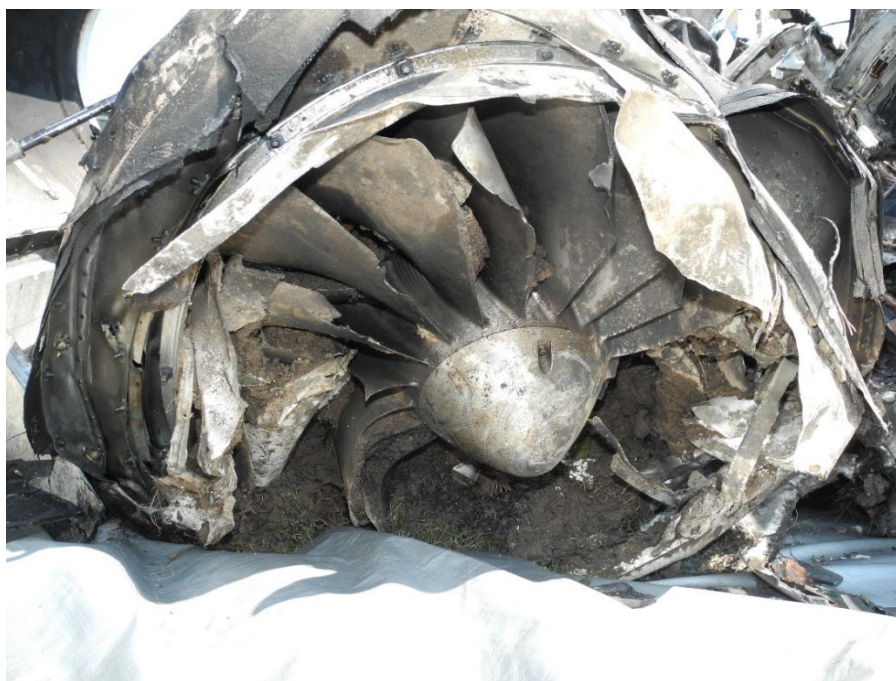
Photo 4 - LH Engine - Fan blades
