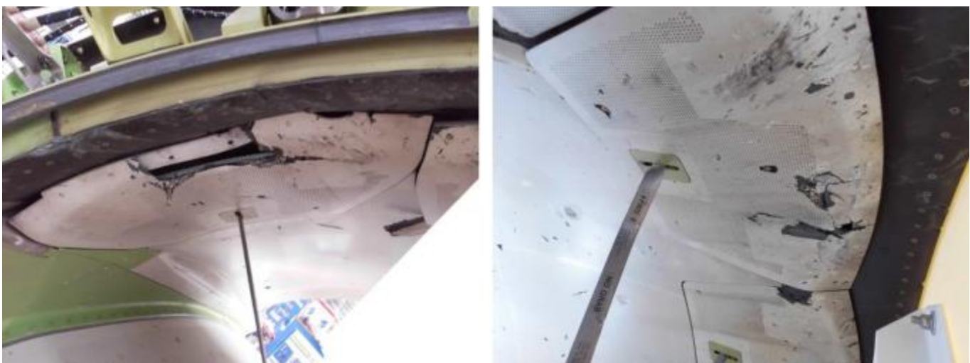
Photo 2- Left Thrust Reverser Blocker Door Impact Damage (L) Door #10, (R) Door #9
