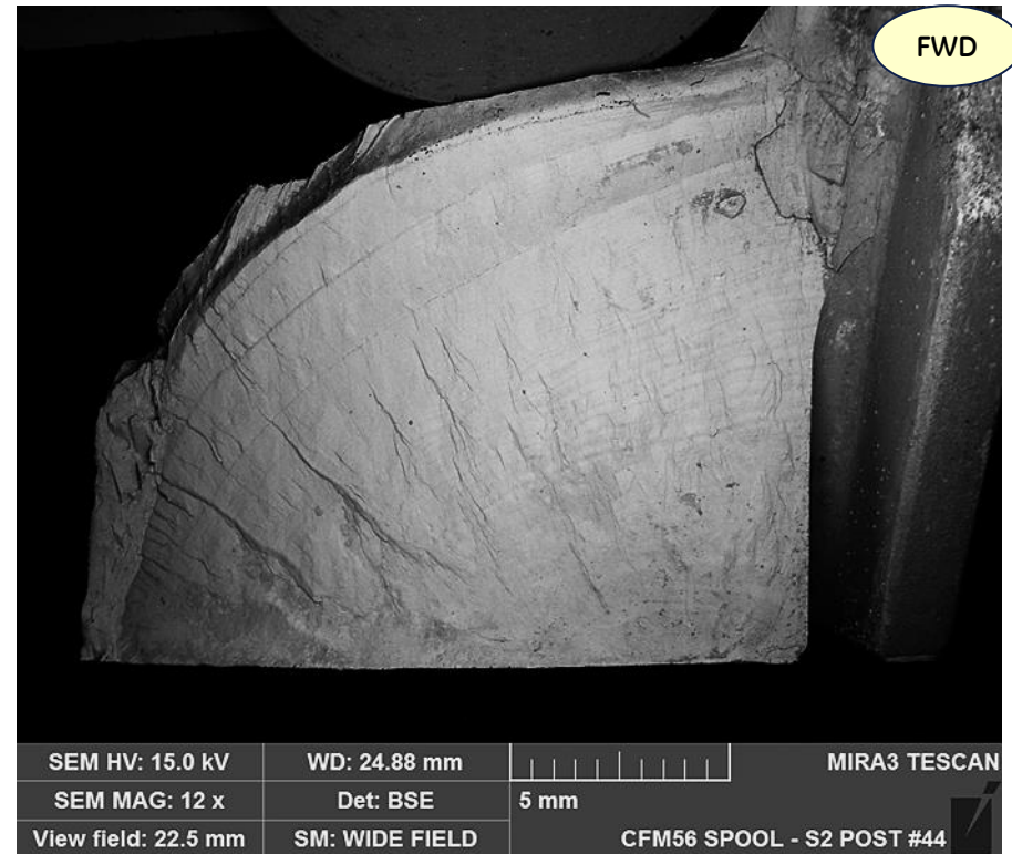
Stg. 1-2 HPC Spool Stg. 2 Disk Post #44 – Outboard Fracture Half - BEI
