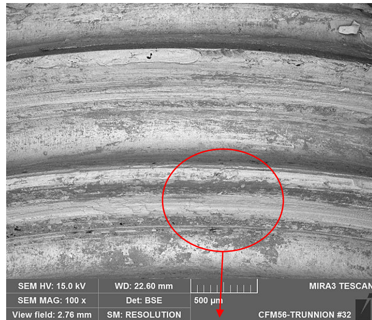
Stg. 1 Vane Trunnion #32 – Upper Thread Contact – BEI
