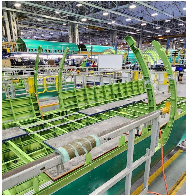
Figure 6. MED plug Edge Frames Installed 40
