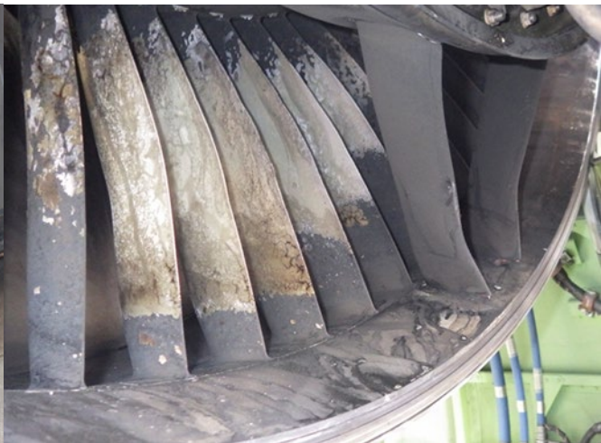
Figure 18. Fan OGV thermal damage
